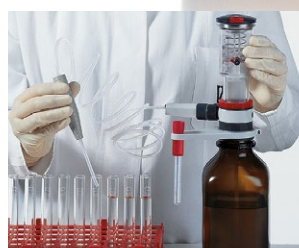
Seriendosierung mit flexiblem Dosierschlauch
